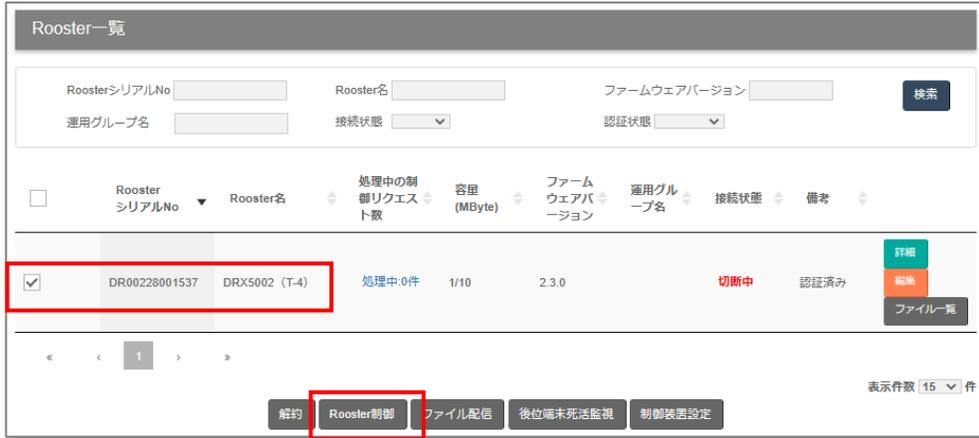
手順3：ダイアログが表示されるので、処理タイミングを設定し“実行”を押下
